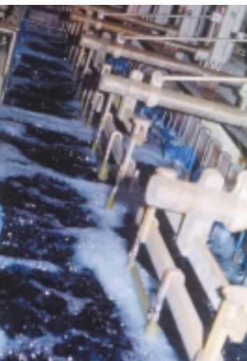
Traitement de surface : bain de cuivre
